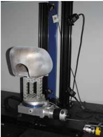
Bild 3. Versuchsaufbau zur Vermessung eines Motorradtanks (Quelle: Fraunhofer IFF)
